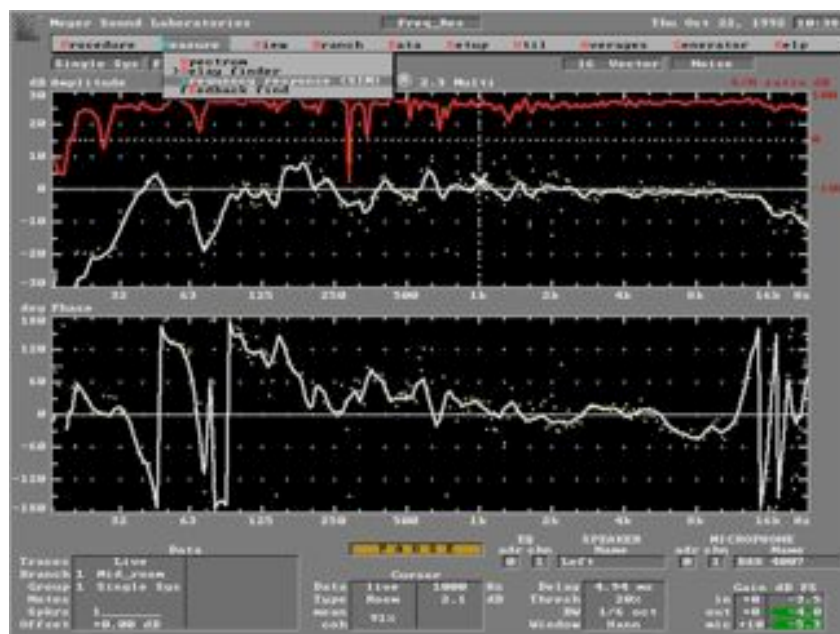
Figura 13. Um exemplo da resposta em freqüência de uma caixa de som (caixa de som + sala). Observe o comportamento da amplitude e da fase.
