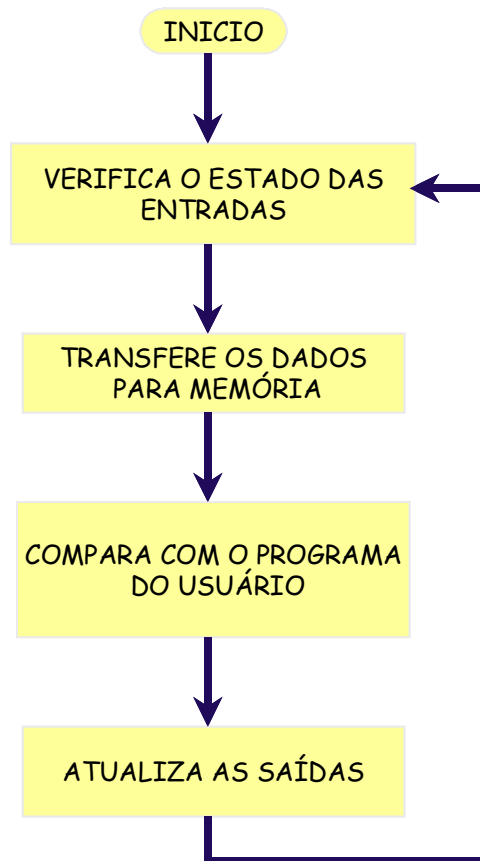
Figura 1.1 – Ciclo de Varredura de um CLP
