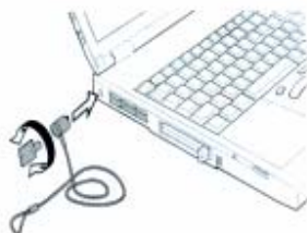
Cabo sendo preso à fenda de segurança
